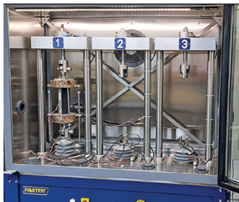
Echipament pentru determinarea rezistenței amestecurilor asfaltice la fisurarea la temperatură scăzută (TSRST)
