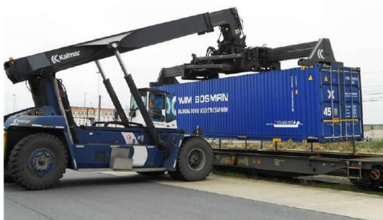
Figura 12 - Exemple de utilaje pe pneuri de tip automacara pentru manipularea containerelor
