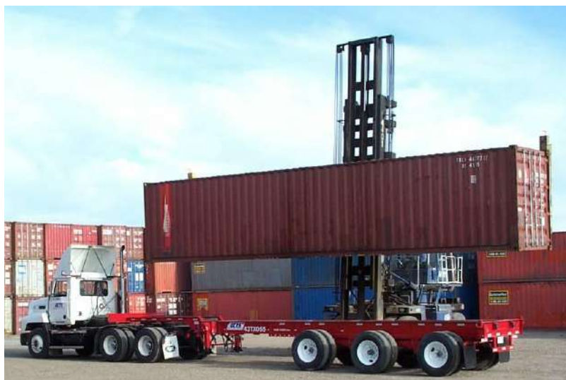
Figura 11 - Exemplu de utilaj pe pneuri de tip motostivuitor pentru manipularea containerelor
