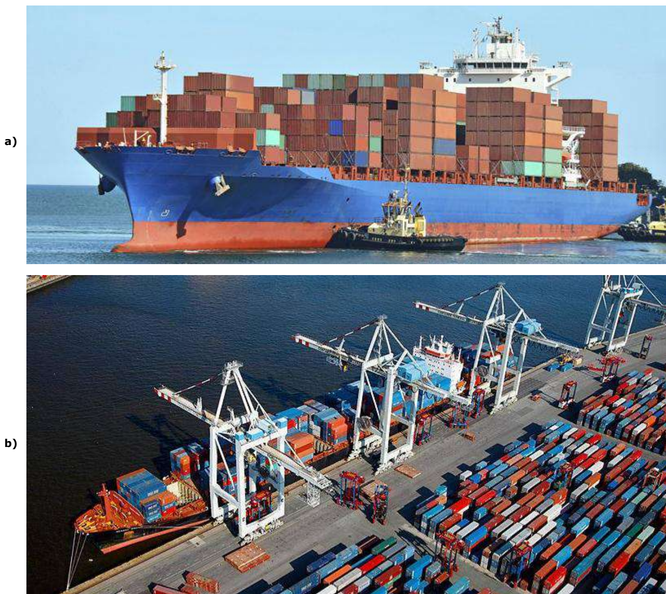
Figura 1 - Transportul maritim al containerelor a) Navă port-container b) Încărcarea-descărcarea navelor port-container
