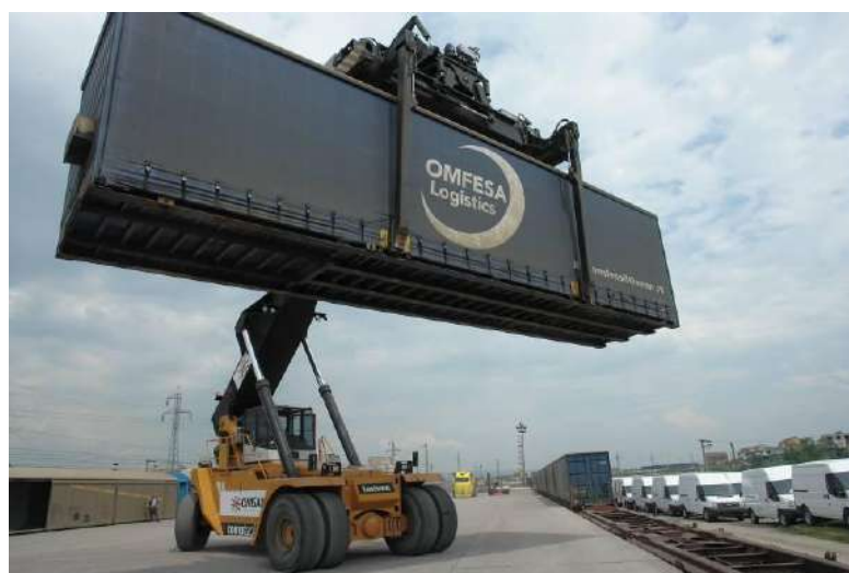
Figura 11 - Exemplu de utilaj pe pneuri de tip motostivuitor pentru manipularea containerelor
