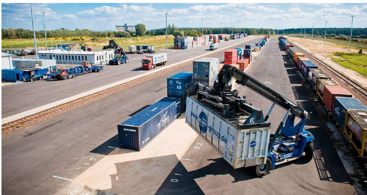
Figura 10 - Exemple de terminale intermodale feroviar-rutier pentru containere a) Cu macarale portal b) Cu utilaje de ridicare pe pneuri
